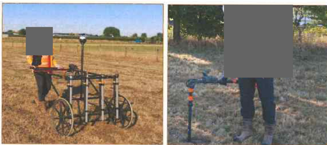
Afbeelding 6: Non-realtime versus (passieve) realtime detectie (Bron: Euro radar).
