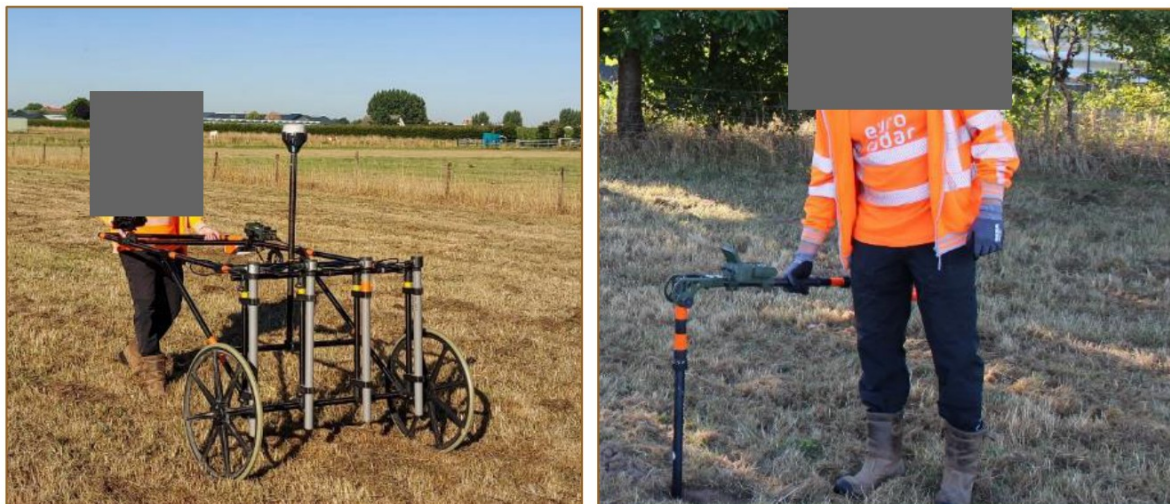
Afbeelding 8: Non-realtime versus (passieve) realtime detectie (Bron: Euroradar).
