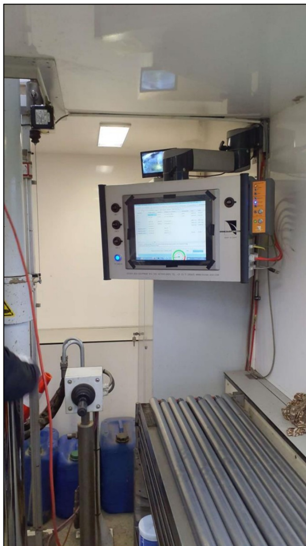
Afb.3 – Uitvoeren (non-) realtime dieptedetectie met sondeermagnetometerconus.
