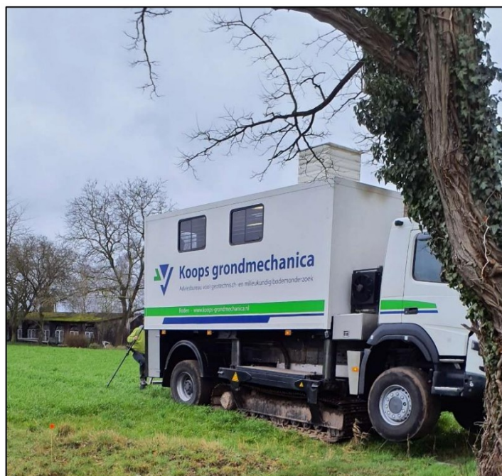
Afb.2 – Half-truck sondeerwagen ter plaatse "Anodepen locatie Doetinchem".
